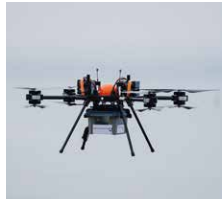
FIGUR 1B: Dronen som ble benyttet var en firemotors Staaker® Logistics drone fra Nordic Unmanned med transportkasse festet under.
